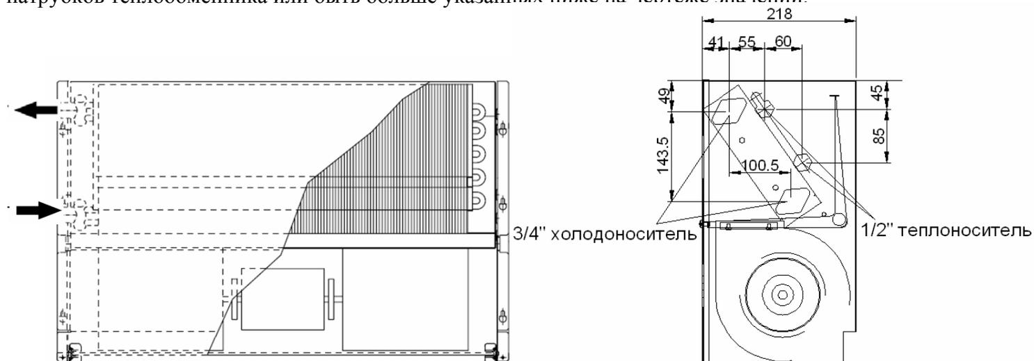
Подключение труб тепло/холодоносителя к фанкойлу должно быть произведено так, чтобы не вызвать чрезмерного механического напряжения на теплообменнике и патрубках.
